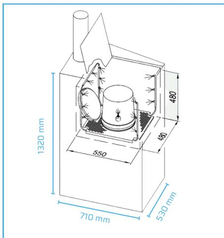
Ce nettoyeur de bidons de peinture permet de nettoyer intérieurement et extérieurement vos récipients d'une capacité maximum de 30 litres
